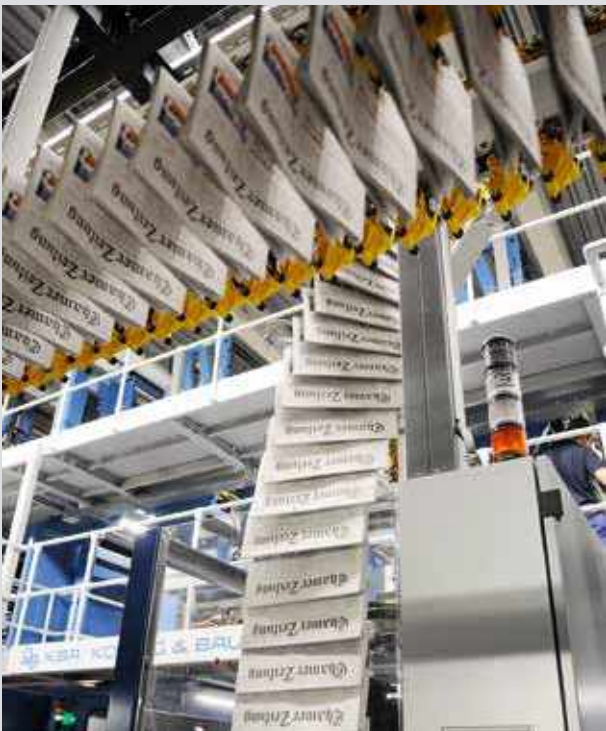
Die Druckmaschine kann in einer Stunde bis zu 45.000 Zeitungen drucken und falzen. (Foto: su)
