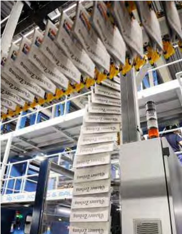
Die Druckmaschine kann in einer Stunde bis zu 45.000 Zeitungen drucken und falzen. (Foto: su)
